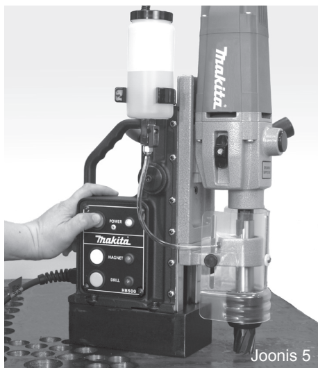
MASINA ELEKTRITOITE SISSELÜLITAMINE
